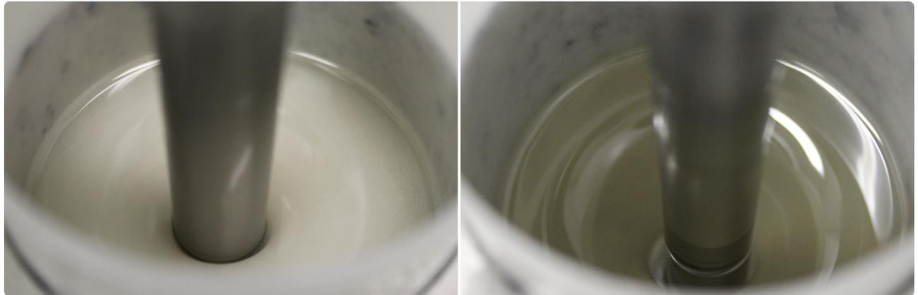
Spontane Entschäumung innerhalb des Lackherstellungsprozesses für ein lösemittelfreies strahlenhärtendes Lacksystem auf Basis eines Urethanacrylates (links: ohne den Einsatz eines Entschäumers, rechts: mit dem Einsatz von BYK-1788 mit einer Dosierung von 0,3 % bezogen auf die Gesamtformulierung).
