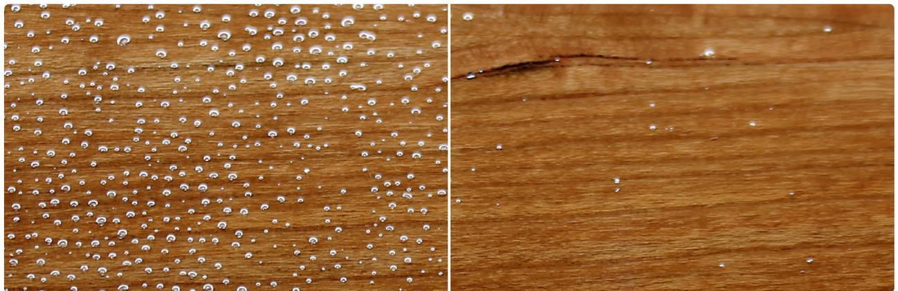
Entschäumende Wirkung von BYK-1799 (rechts), eingesetzt mit 0,05 % auf die Gesamtformulierung, im Vergleich zum System ohne Entschäumer (links) für ein 100 % UV-härtendes Klarlacksystem, appliziert mit einer Moltopren-Rolle.
