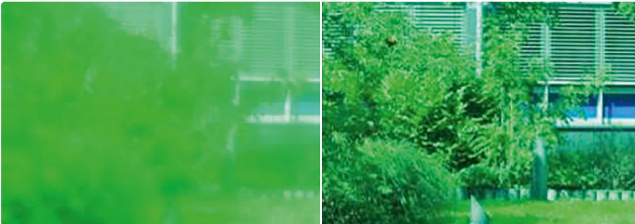
Exzellente Transparenz des Lacksystems auf Basis eines Phthalocyanin-Pigmentes als Resultat gezielter Additivauswahl (rechts) im Vergleich zur Transparenz des Lacksystems bei unzureichender Pigmentstabilisierung (links).
