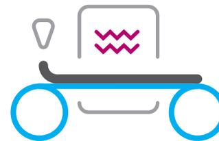
通过不同涂布及干燥工艺流程将电极浆料涂敷于集流体上。涂层制备过程中使用助剂可改善最终性能。
