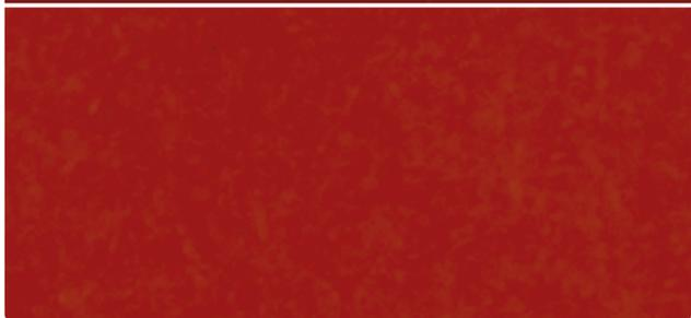
解絮凝状态显示漆膜的颜色朝黄相的方向发生迁移。
