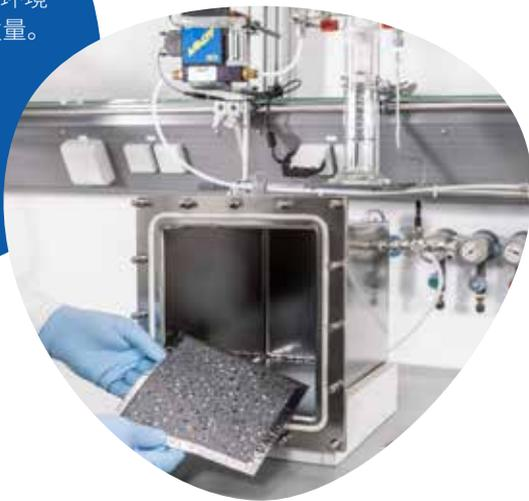
采用上述两种仪器, 样品材料的挥发物收集在一个 Tenax 试管中 (图 06)。通过采用气相色谱和质子光谱仪等分析仪器, 可进行定性及定量测定。
