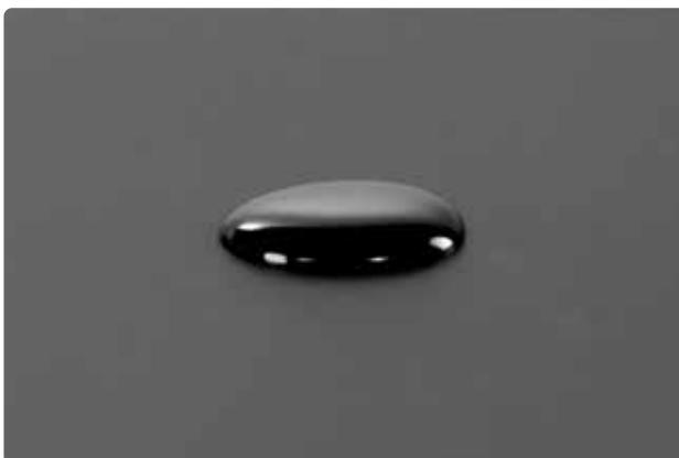
シリコン系添加剤による表面張力の低下: 基材の濡れ性向上
